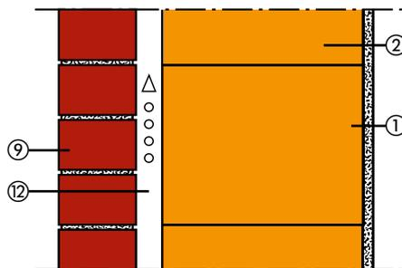
**6. Zweischaliges Außenmauerwerk mit Luftschicht**
