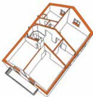
Es ist erforderlich, dass der obere Wandabschluss „abgedeckelt“ wird. Die Minimalanforderung kann mit einem Abgleich aus Mörtel erfüllt werden. Empfehlenswert ist der zusätzliche Einbau einer winddichten Trennschicht aus Bitumenpappe.
