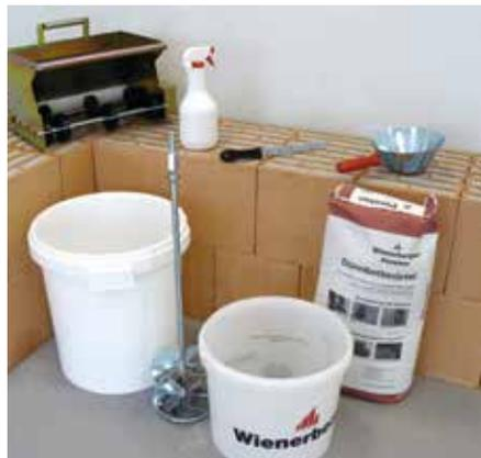
VD-Mörtelrolle, Dünnbettmörtel, sauberer Anrühreimer oder Mörtelkübel, leistungsfähiger Quirl, Greifhilfen.
